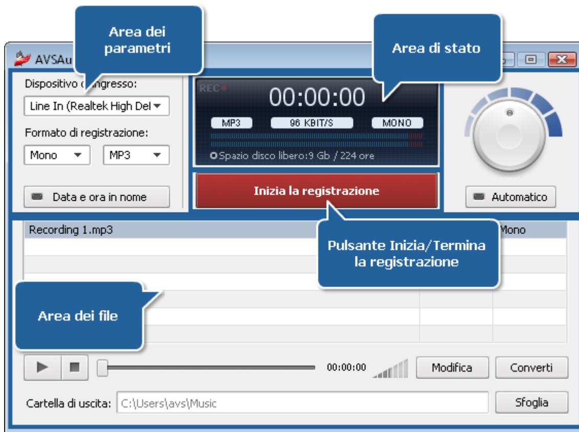
L'**Area dei parametri** è lo spazio dove potete selezionare il dispositivo di ingresso e il formato per le registrazione di uscita, regolare il livello del segnale in entrata e specificare il nome file;
